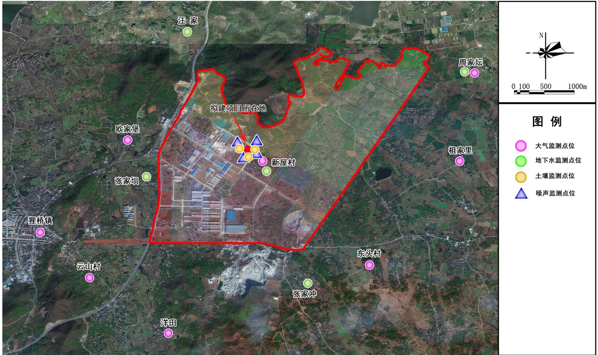
图 3-2-1 项目大气、地下水、土壤、噪声现状监测图
