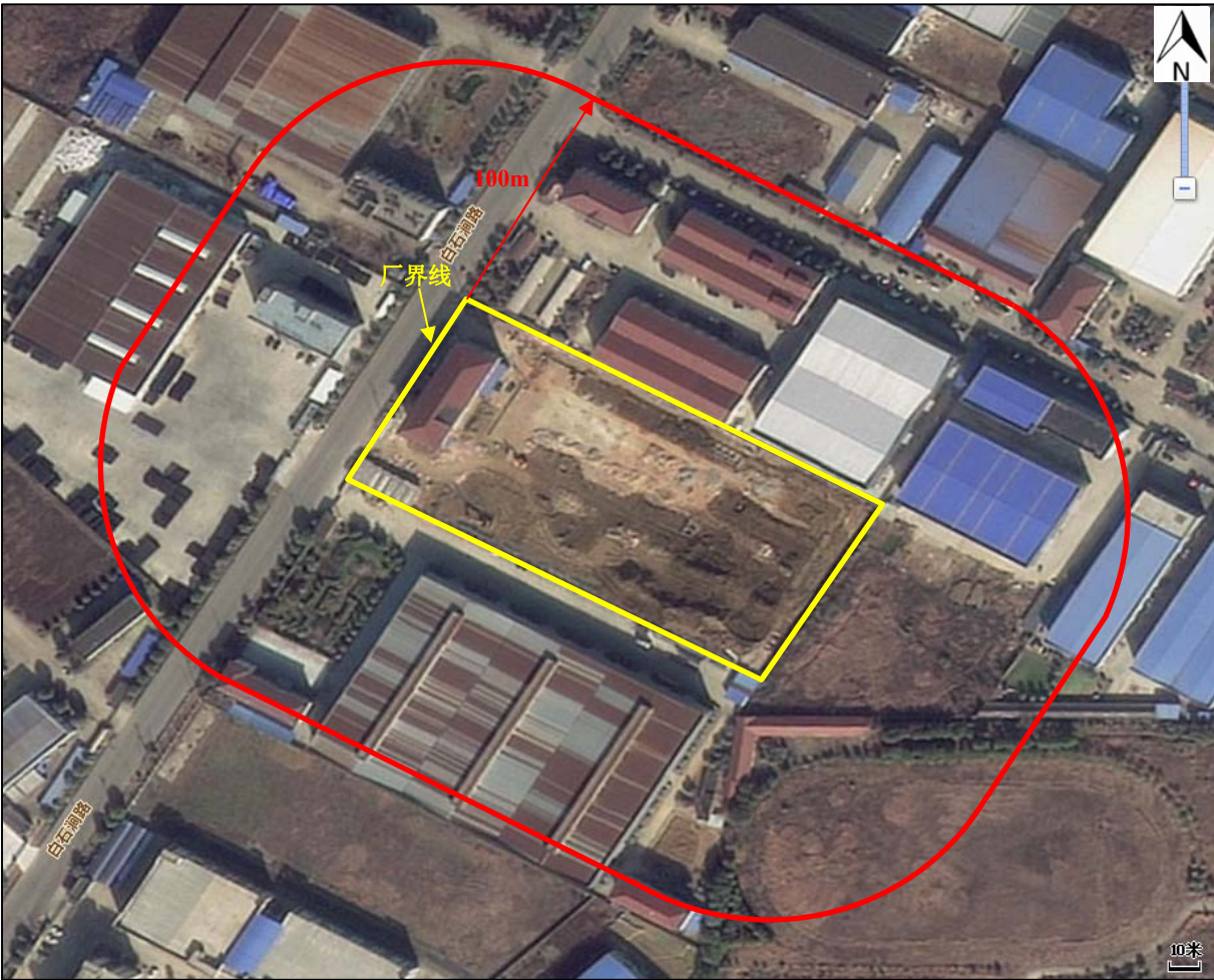
图 5.1-1 厂区环境防护距离包络线示意图
