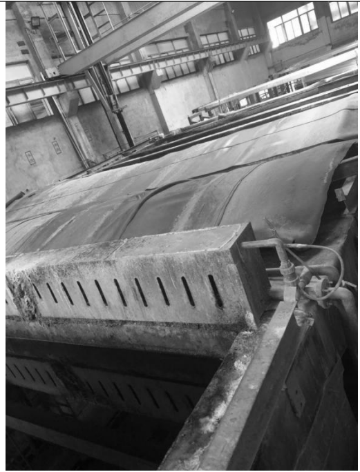
阳极氧化线槽边抽风系统堵塞
