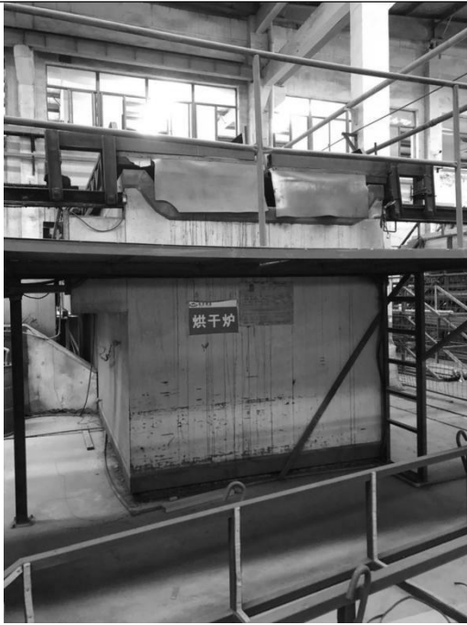
固化炉有机废气未处理排放
