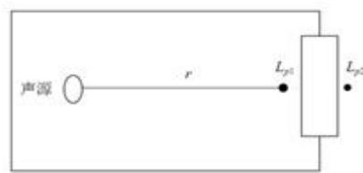
图4-1 室内声源等效为室外声源图例
