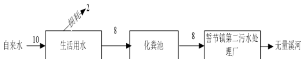
图 2-1 扩建前项目水平衡图 单位：t/d
