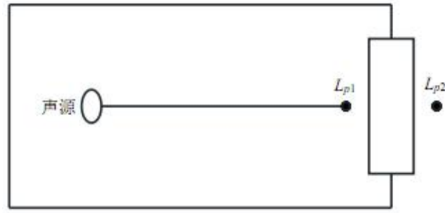
图 4.4.4-1 室内声源等效为室外声源示意图
