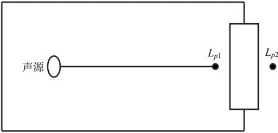
图 4-3 室内声源等效为室外声源图例
