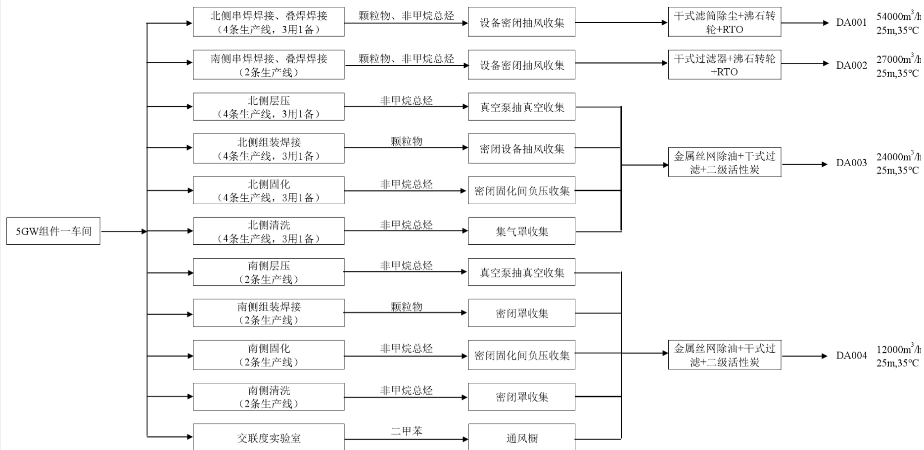
图 4-1 一车间废气收集方式示意图
