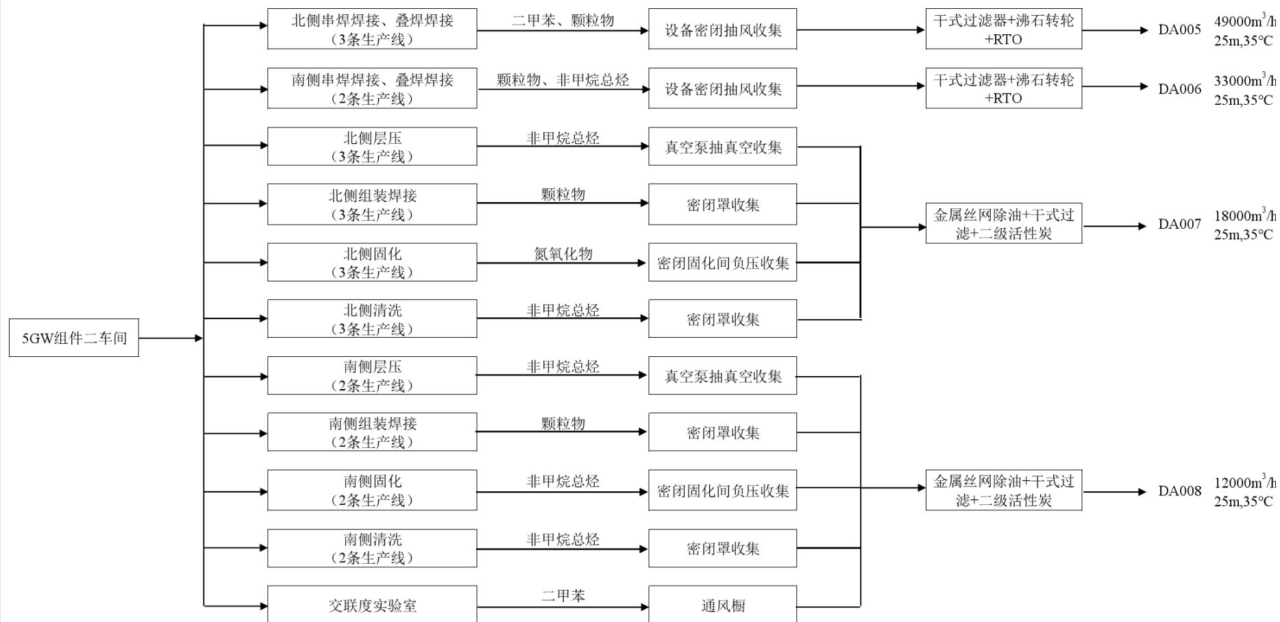
图 4-2 二车间废气收集方式示意图
