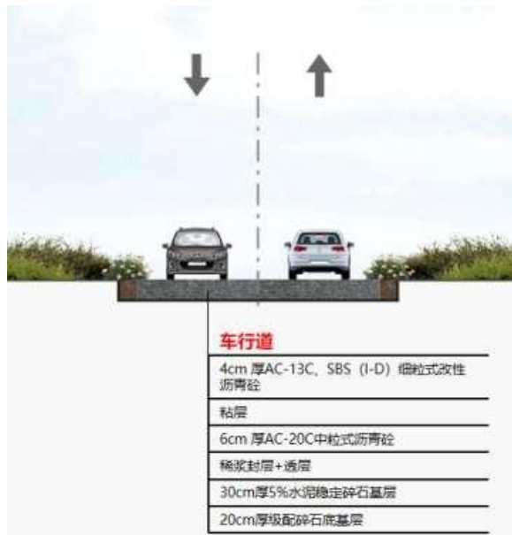
图 2-5 机动车道结构设计图
