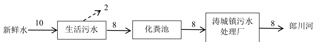
图 2.2-3 项目水平衡图 ( \text{m}^3/\text{d} )
