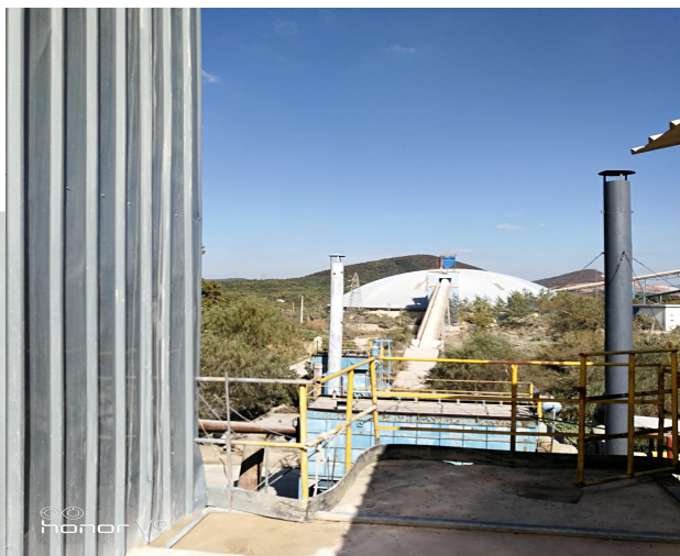
破碎站除尘器和排气筒和输送廊道
