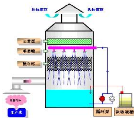
图 6.2-1 酸性废气喷淋塔处理工艺流程图
