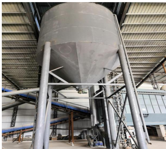
收集尘储罐（两个 200T）
