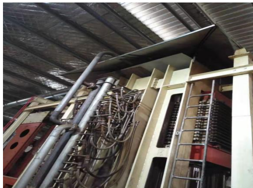
热压废气集气整改后
