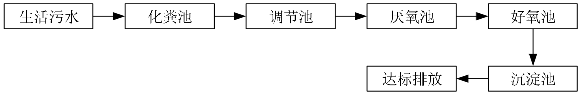
图 3-1 废水处理工艺流程图
