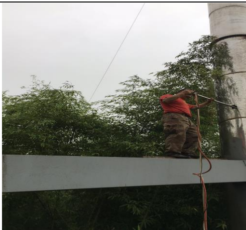
有组织废气监测图片-锅炉废气出口 (1)
