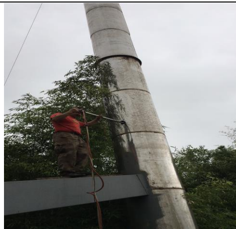
有组织废气监测图片-锅炉废气出口(2)
