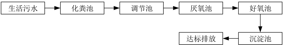
图 3-1 废水处理工艺流程图
