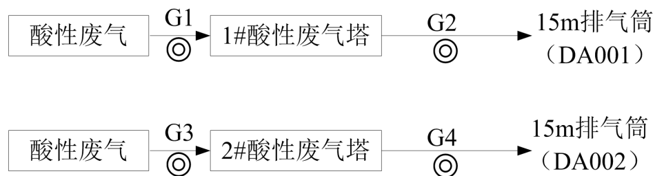
图 3-3 酸性废气净化装置处理工艺流程及监测点位图
