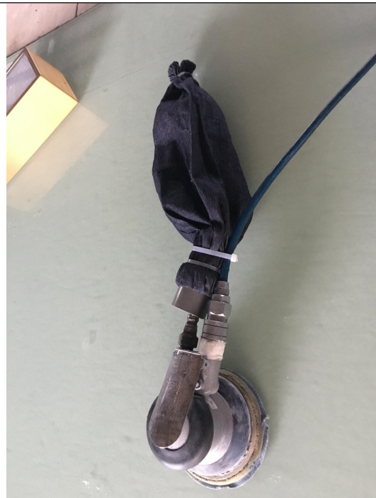
气动打磨机自带除尘设备
