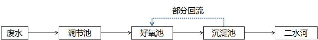
图 4-2 厂区污水里站治理工艺流程图
