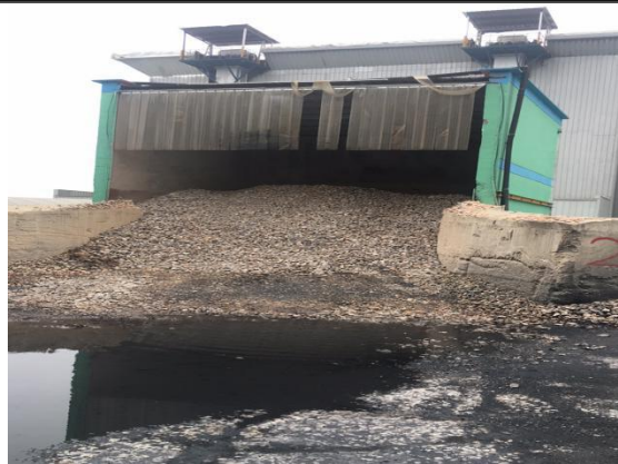
4#石灰窑组投料口（水喷淋+软帘）
