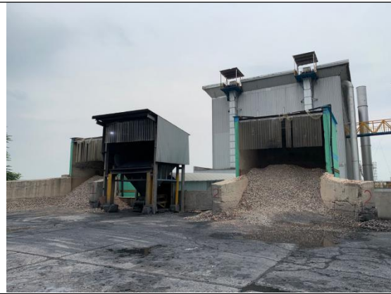
1#石灰窑组投料口 (水喷淋+软帘)
