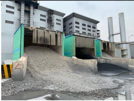
3#石灰窑组投料口（水喷淋+软帘）
