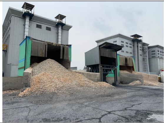
2#石灰窑组投料口 (水喷淋+软帘)
