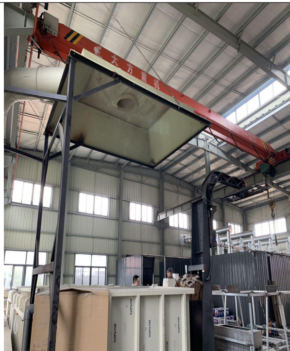
图 4-1 酸性废气收集装置
