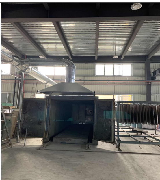
固化废气收集装置
