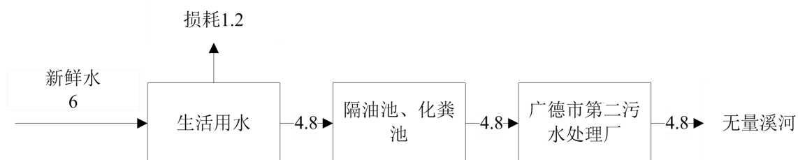
图 2-1 项目水平衡图 (t/d)
