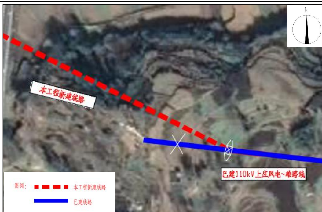
图 1-3 改接方案示意图
