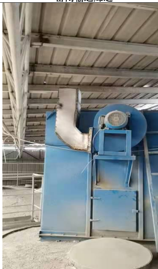
仓顶布袋除尘器、1#排气筒、3#排气筒
