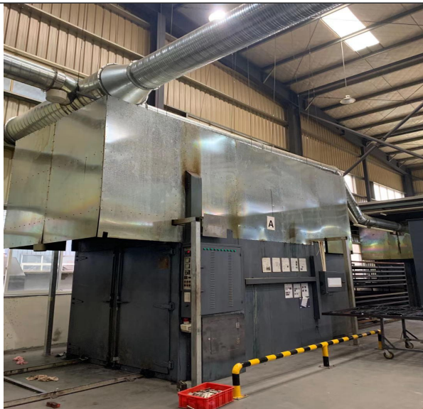
固化烤炉废气收集措施
