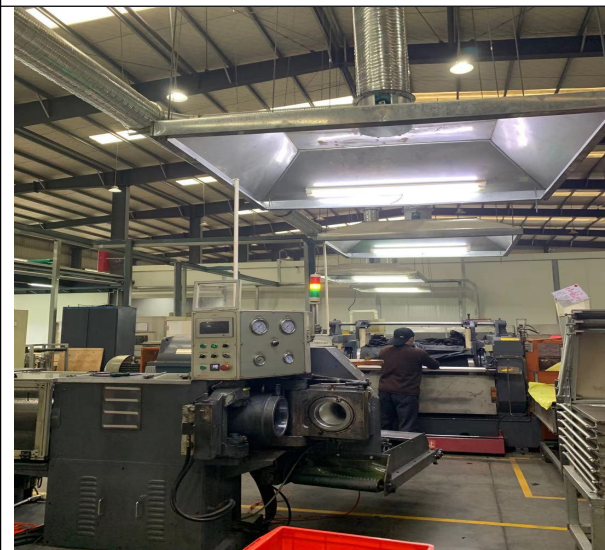
挤出机废气收集措施
