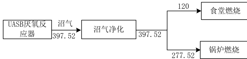
图 2.3-5 其他季节沼气利用平衡图（m 3 /d）
