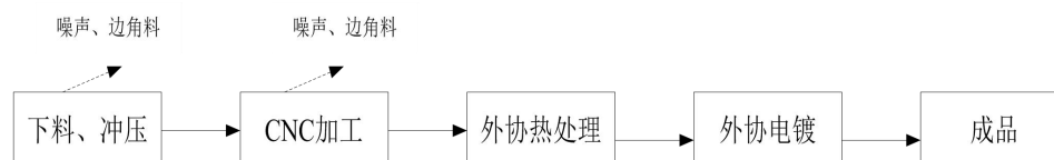
图 2-10 汽车金属配件工艺流程图
