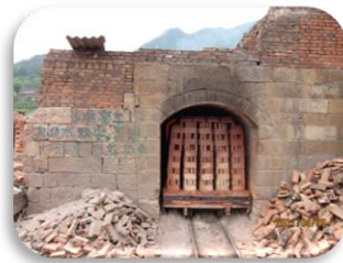
飞灰生产烧结砖， 二恶英大幅增加 铬渣制烧结砖，砖体呈黄色（ 六价铬 ）
