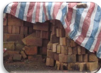
飞灰生产烧结砖， 二恶英大幅增加 铬渣制烧结砖，砖体呈黄色（ 六价铬 ）
