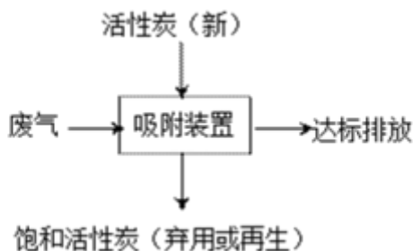
图 6.1-6 活性炭吸附装置处理工艺流程图
