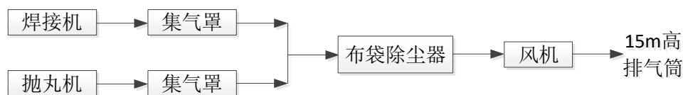
图 4-1 废气收集管线示意图
