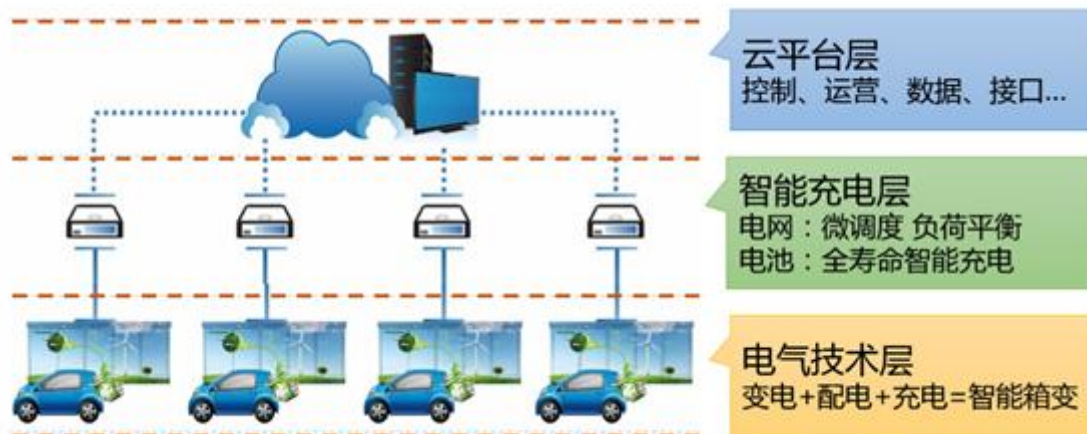
图 2-5 新能源汽车充电系统技术架构图
