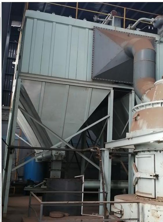
电解铝废渣破碎废气处理设施（2#排气筒）
