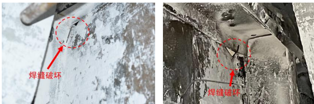
图 12 事故 D 灰斗壁板拼接焊缝破坏
