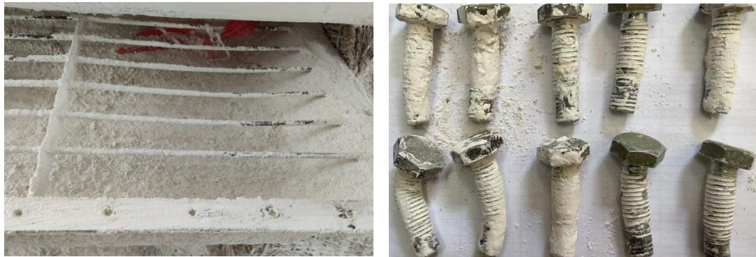
图 17 事故 D 灰斗底部流化槽破坏情况
