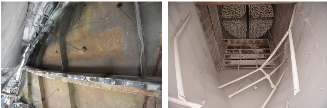
图 11 事故 D 灰斗壁板外鼓变形
