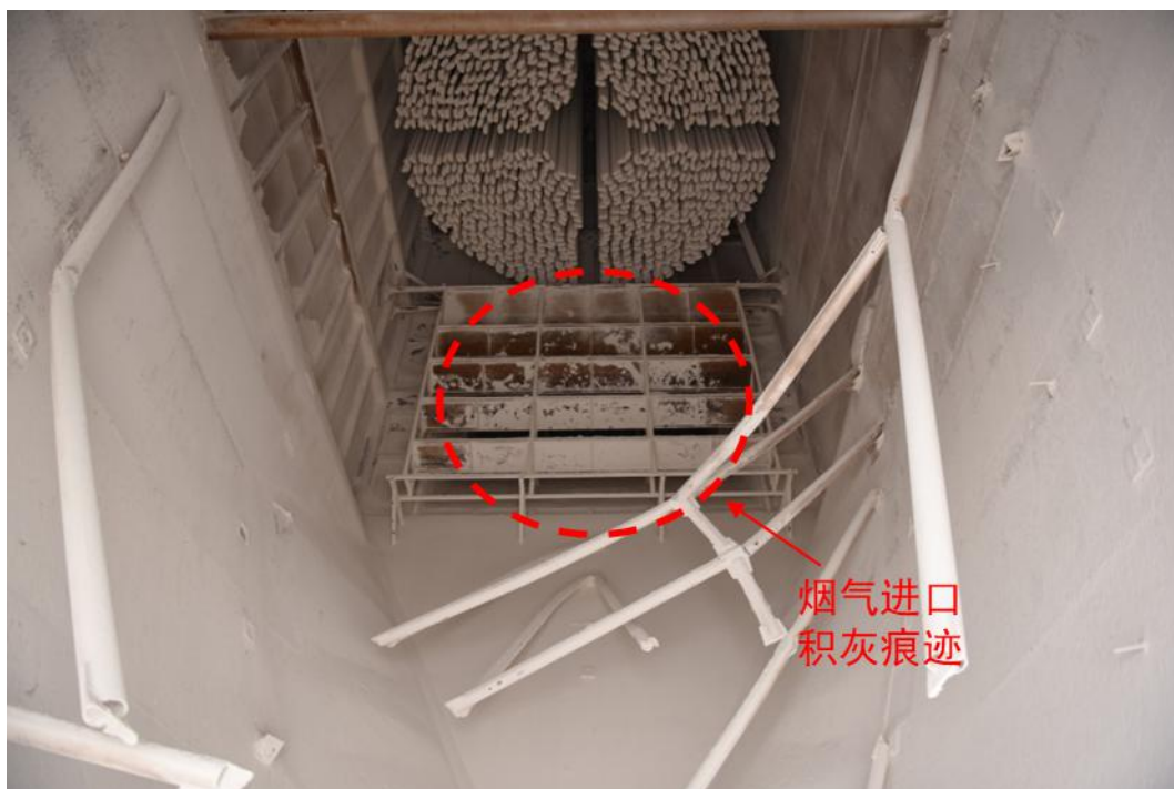
图 22 事故 D 灰斗除尘器烟气进口积灰位置
