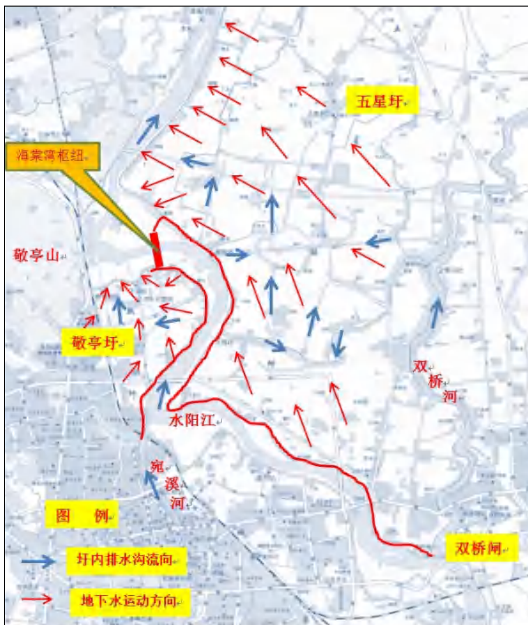
图 5.4.1-1 敬亭圩、五星圩圩内排水及地下水运动方向示意图
