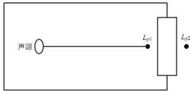
图 4.4.4-1 室内声源等效为室外声源示意图
