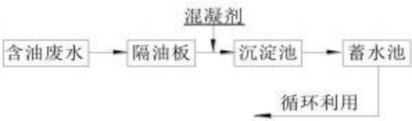
图 5-1 含油废水处理流程图
