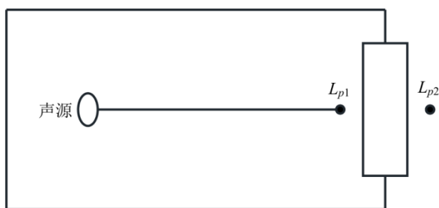
图 4-1 室内声源等效为室外声源图例
