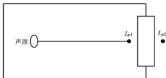
图 4-2 室内声源等效为室外声源图例
