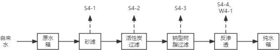
图 2-7 纯水制备工艺流程图
