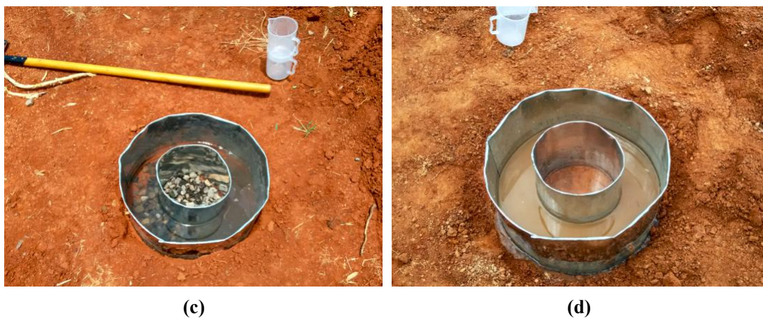
图 5-2-14 坑法渗水试验现场试验照片
