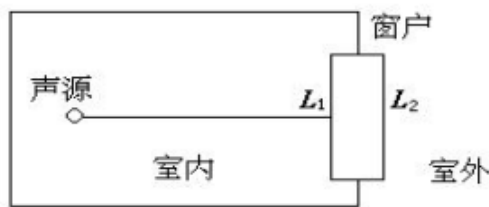
图 5.4-1 室内声源等效为室外声源示意图
