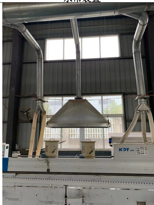
封边废气收集装置
