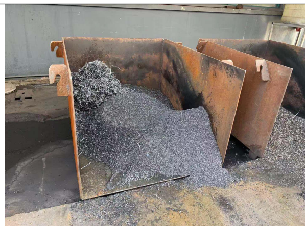
1#车间北侧含切削液清渣暂存区及废切削液暂存池（地下，3.5m×2m×1.2m）
