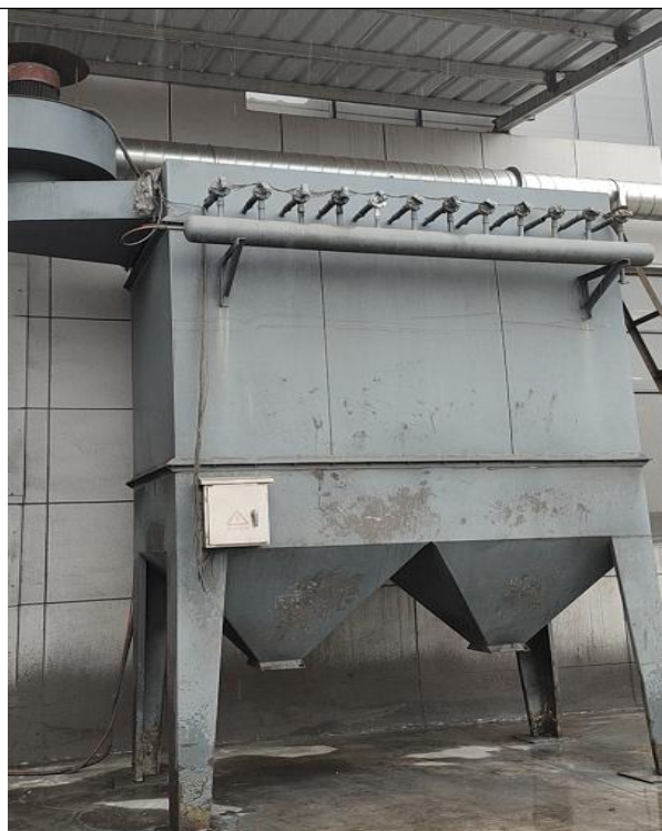
树脂砂处理线粉尘处理装置（布袋除尘器）
