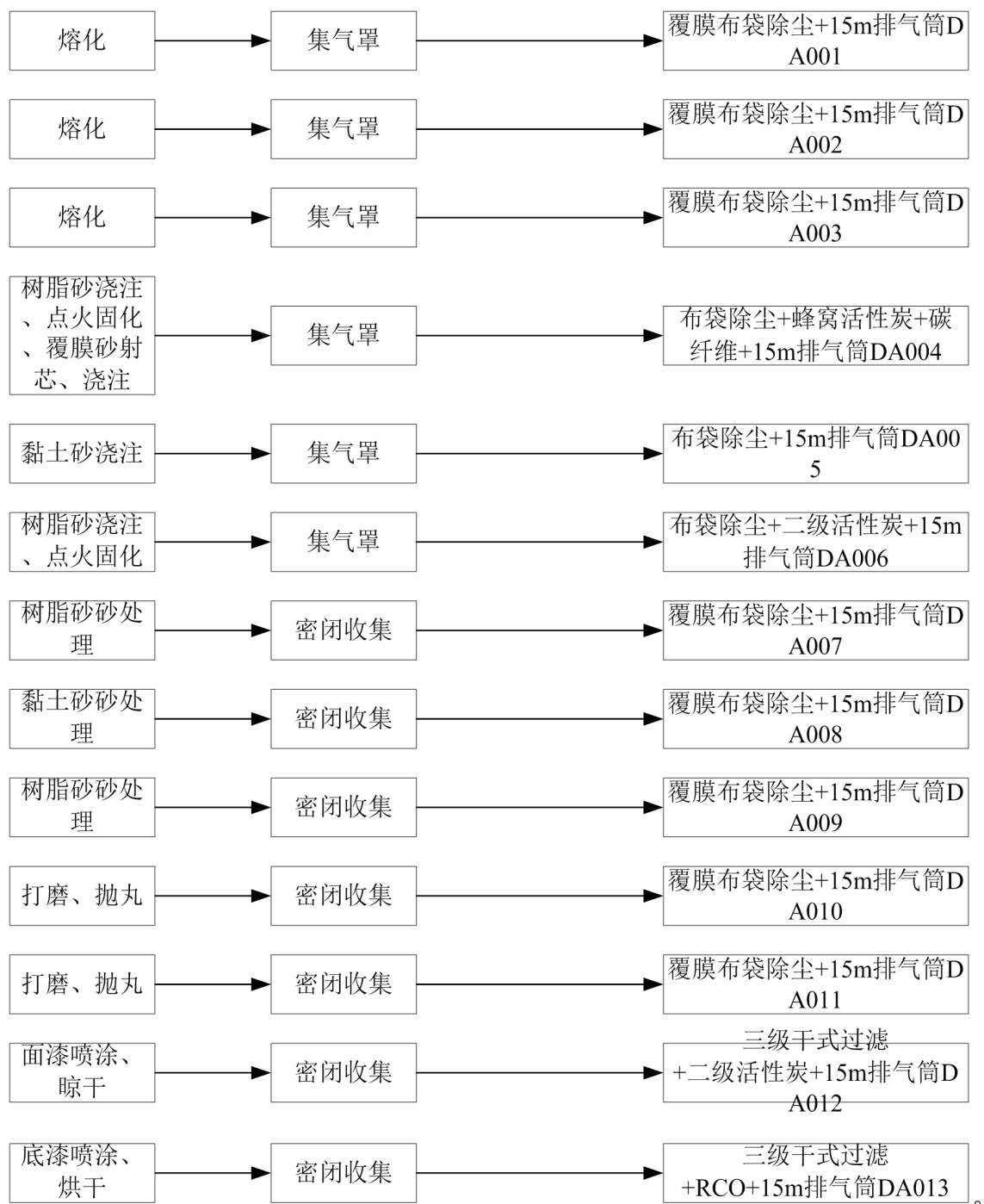
图6.1-1 本项目废气治理工艺流程
