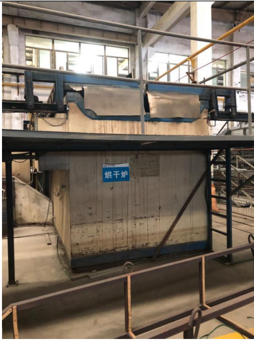
固化炉有机废气未处理排放
