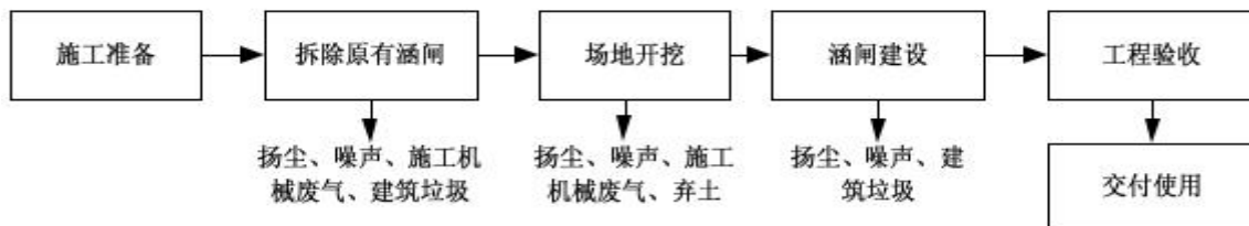
图5-3 渠系建筑物工程施工工艺流程及产污节点示意图
