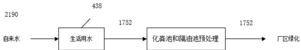
图 2-1 水平衡图（单位：m³/a）
